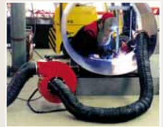
Tragbarer Ventilator in der Anwendung mit einer Magnethaube beim Schweißen
